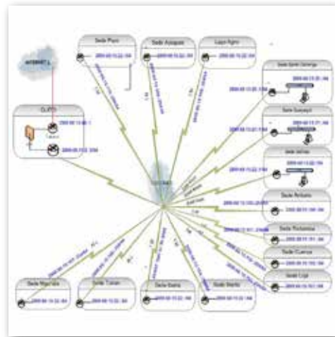
Figura1. Esquema del direccionamiento IPv6 de la red WAN.
